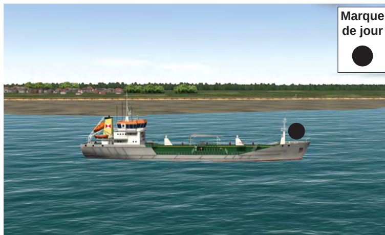
1.3.11.B. — Navire au mouillage - Marque de jour (Règle 30 a-i).
