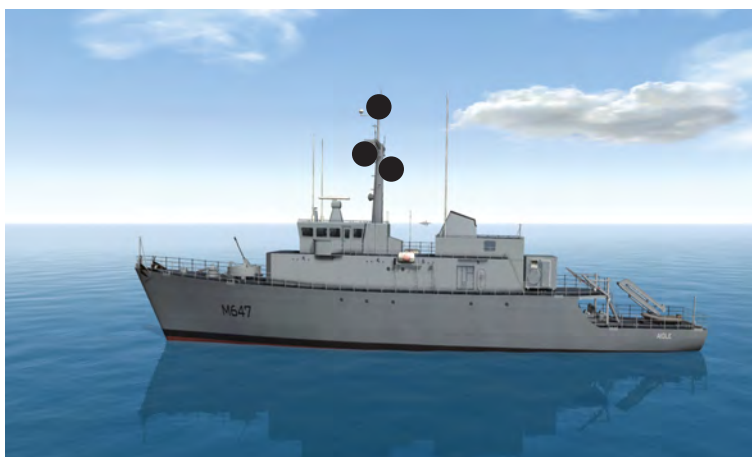
1.3.8.Q. — Navire effectuant des opérations de déminage - Marques de jour (Règle 27 f).
