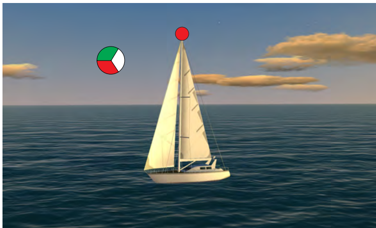
1.3.6.B. — Navire à voile de moins de 20 m de long portant un fanal en tête de mât.
