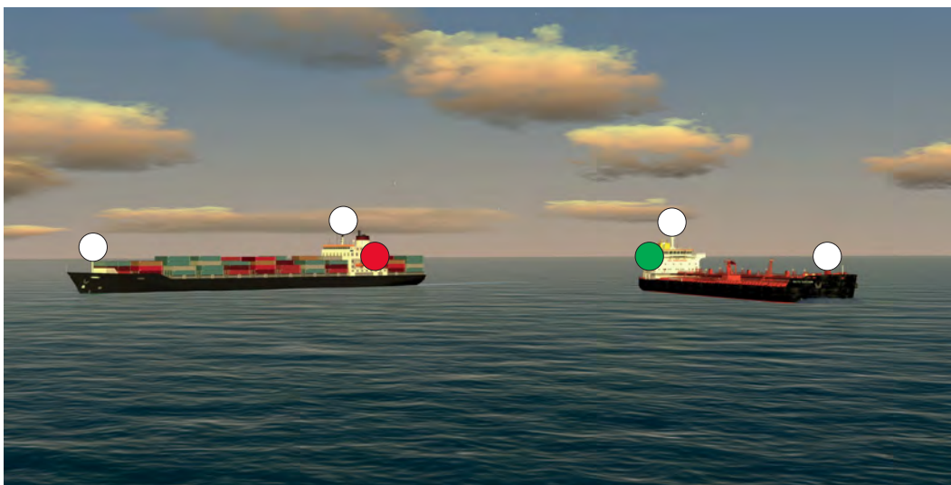
1.3.4.B. — Feux de tête de mât et feux de côté de navires faisant route (Règle 23 a).
