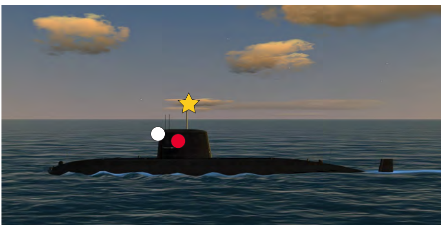
1.3.4.I. — Sous-marin faisant route vers la gauche de l'observateur.
