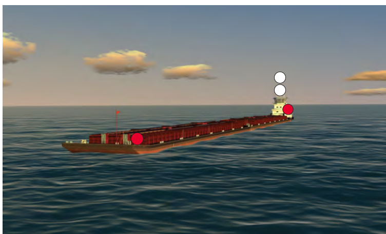
1.3.5.F. — Pousseur et poussés faisant route vers la gauche de l'observateur - Quel qu'en soit le nombre, le groupe de poussés montre les mêmes feux que s'il n'y avait qu'un seul navire (Règle 24 f).
