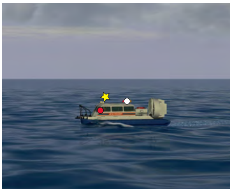
1.3.4.C. — Aéroglisseur exploité sans tirant d'eau (Règle 23 b).
